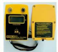
Blasting Ohm Meter
